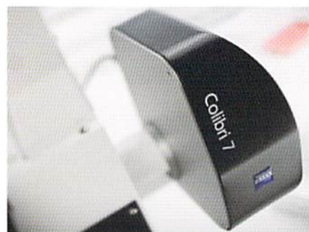
最大7色の励起光を搭載できる高輝度LED光源Colibri
