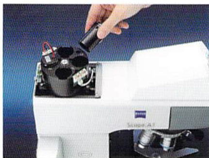
LEDターレットへのLEDモジュールの追加は工具不要で簡単・安全
